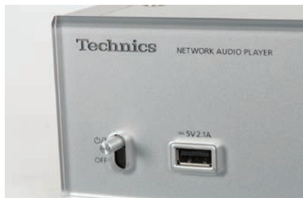
Jedno z dwóch wejść USB umieszczono na przednim panelu. Oprócz nośników pamięci, można tu podłączyć odtwarzacze przenośne (w tym sprzęt Apple).
