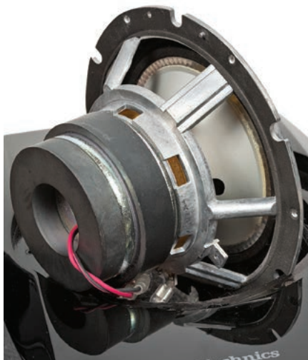
Widoczna od frontu, płaska część membrany nisko-średniotonowego opiera się na konwencjonalnej części stożkowej, połączonej z cewką; taka „podwójna” membrana będzie relatywnie ciężka
