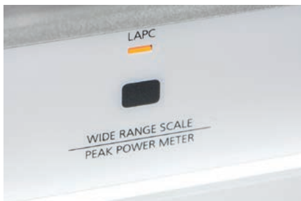
Podobnie jak większy R1, wzmacniacz SU-C700 wyposażono w układ LAPC dopasowujący parametry końcówek mocy do charakterystyki obciążenia.
