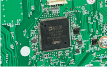
Procesory DSP Analog Devices Sharc znajdują się najczęściej w urządzeniach wielokanałowych; w odtwarzaczu Technics układ ten służy do dekodowania plików.
