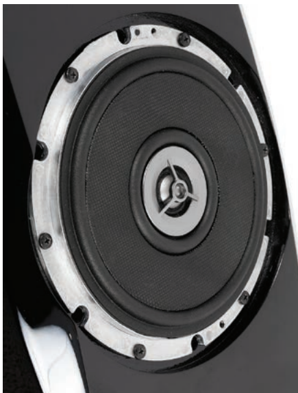
Po zdjęciu pierścienia maskującego widok będzie mniej elegancki, ale technicznie obiecujący – układ koncentryczny zbudowano na solidnym, aluminiowym koszu.
