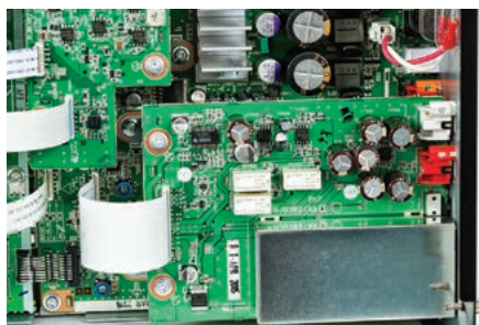
Do urządzenia gruntownie cyfrowego dodano analogową płytkę z dwoma wejściami – liniowym i gramofonowym (przedwzmacniacz korekcyjny pod metalowym ekranem).
