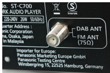
Wśród układów ST-C700 znajduje się tuner, zatem jest też gniazdo na zewnętrzną antenę.
