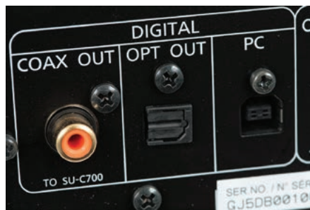
Wskaźówka obok wyjścia koaksjalnego sugeruje, aby w ten sposób podłączyć wzmacniacz, co jednak ograniczy parametry transmisji do formatu PCM 24/192.
