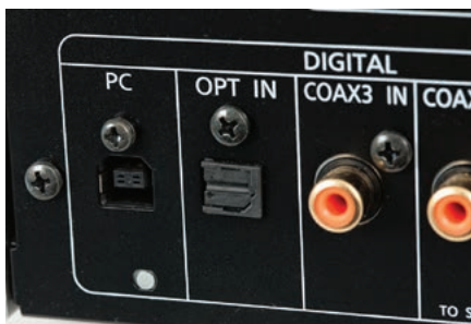
Gniazdo USB, opisane jako PC, może być mylące – do Technicsa podłączymy również komputery Apple.
