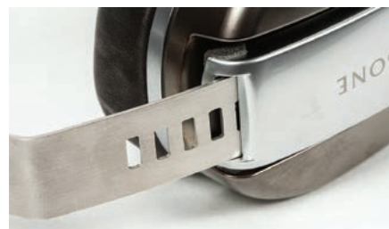
Za regulację odpowiadają dwa elementy – prosty mechanizm zapadkowy i elastyczne mocowanie muszli na odchylających się przegubach.
