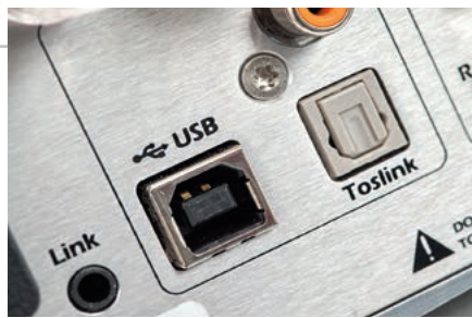
Wejścia cyfrowe grają coraz większą rolę, a USB potrafi współpracować nie tylko z komputerem, lecz również z urządzeniami przenośnymi Apple (pod warunkiem zastosowania przejściówki).
