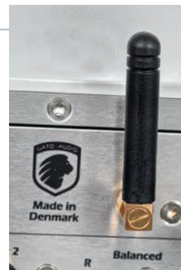
Uzupełnieniem wejść cyfrowych jest także system Bluetooth, antenę wyprowadzono na zewnątrz, co było konieczne w związku z metalową obudową.
