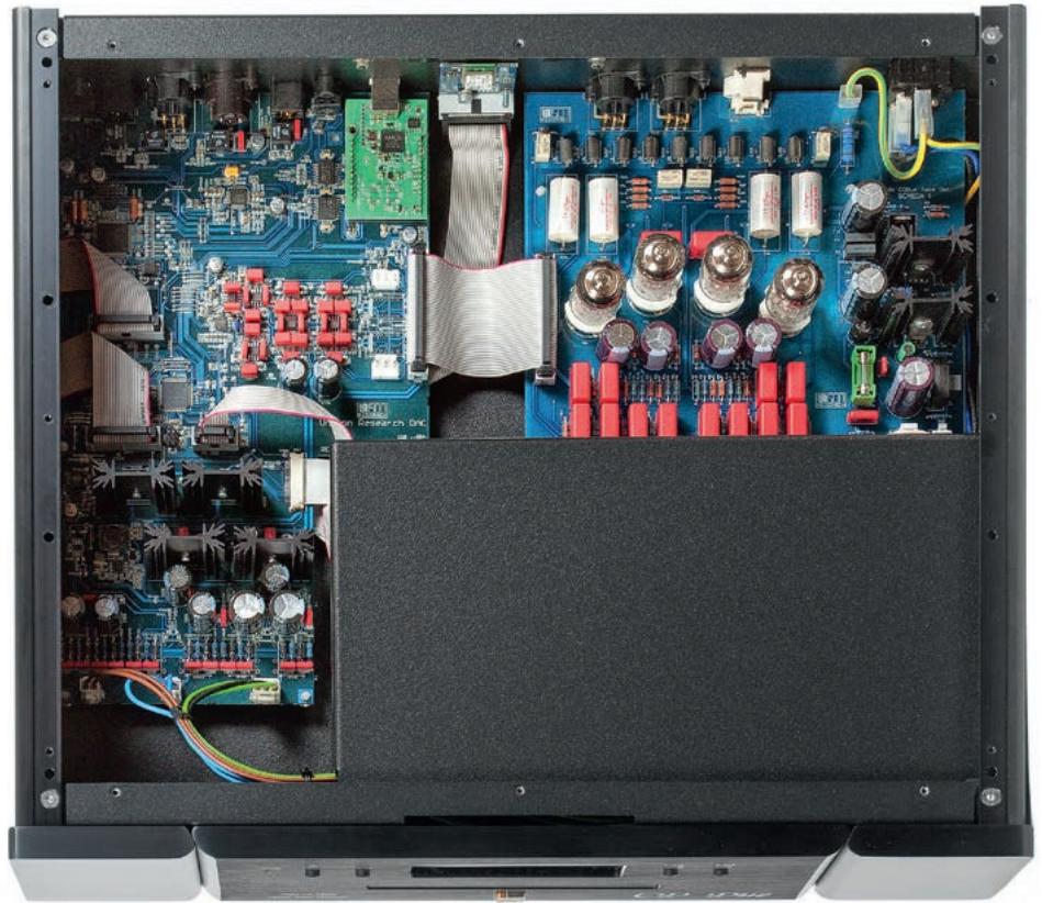
We wnętrzu znajduje się kilka stref, oddzielono obwody cyfrowe, analogowe i napęd.
