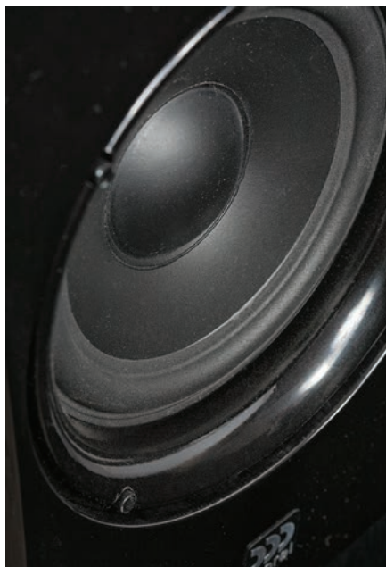
15-cm głośnik średniotonowy udało się odsonić (zdjęcia jego indywidualną, metalową maskownicę - wtedy jednak okazało się, że nakładka przeciwpylkowa nie ma średnicy 75 mm, ale około 50 mm.
