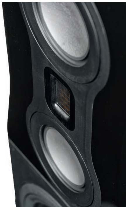
Krawędzie obudowy na wysokości sekcji średnio-wysokotonowej zostały głębiej wyprofilowane – to nie dekoracja, ale zgodny z teorią zabieg poprawiający warunki propagacji fal.
