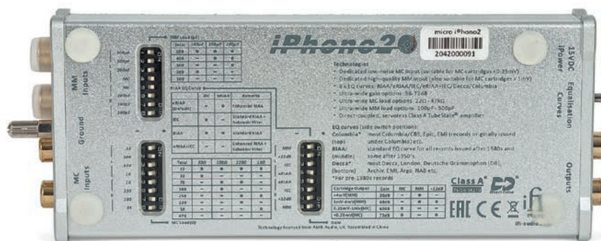
Przełącznikami hebelkowymi ustalamy większość parametrów, rozdzielono nawet tory kanałów prawego i lewego.
