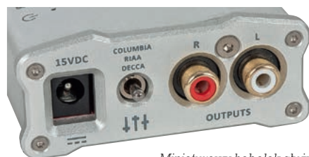
Miniaturowy hebelkę służy do wyboru krzywej korekcji, w zdecydowanej większości sytuacji wskaże środkową pozycję – uniwersalny standard RIAA.
