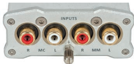
Dwa niezależne wejścia wynikają z rozdzielania torów dla wkładek MM oraz MC.
