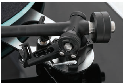
Ramie RB300 zastąpiła nowa konstrukcja o oznaczeniu RB330, podstawowe elementy regulacyjne, takie jak duże pokrętko precyzyjnej nastawy siły nacisku oraz ułożony na dole „suwak” anti-skatingu, pozostały bez zmian – jednak ten ostatni działa teraz znacznie lepiej.
