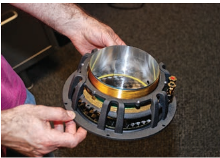
Głośnik niskotonowy modelu Q5. Po zdjęciu magnesu widać ogromną cewkę
