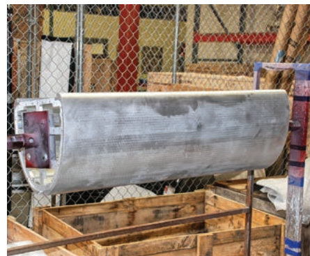
Obudowa kolumn S5 przygotowana do malowania.
