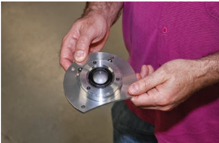
Berylowy głośnik wysokotonowy modelu Q.
