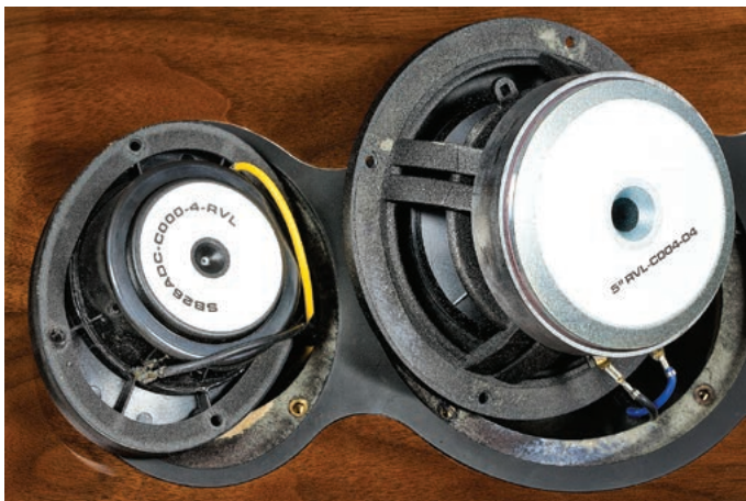
Głośniki wysokotonowy i średniotonowy wyglądają konwencjonalnie, ale mają wszystkie atrybuty dobrej klasy.
