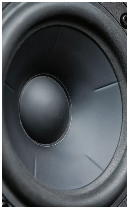
Głośnik średniotonowy i sposób jego użycia budzi uznanie; relatywnie niewielki, 12-cm, pracuje z niską pierwszą częstotliwością podziału (270 Hz), co wskazuje na jego dużą wytrzymałość. Na aluminiowej membranie widać delikatne pęgi zwiększające dodatkowo jej sztywność.
