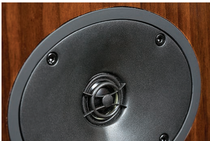
Przed aluminiową kopułką utworzono układ „soczewek akustycznych”, na który składa się zarówno wyprofilowany front, jak i dyfuzory bezpośrednio przed membraną, jednocześnie chroniące ją przed uszkodzeniem mechanicznym.
