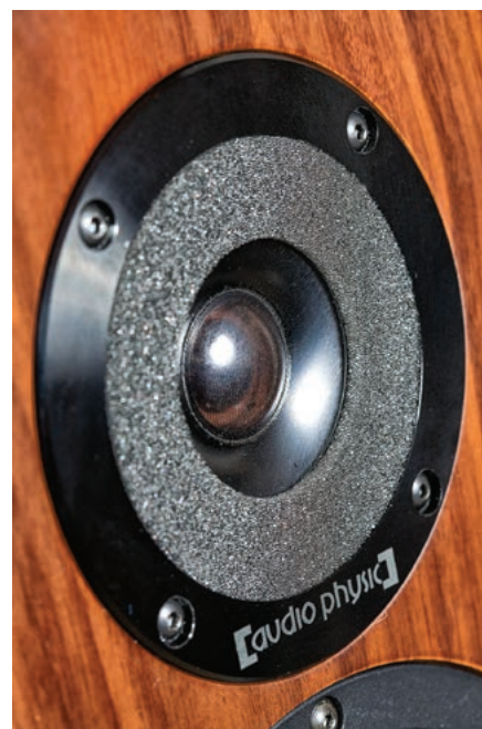
Do spójki aluminiowy stożek i tekstylna kopułka, prowadzone przez 25-mm cewkę. Oryginalny przetwornik wysokotonowy Audio Physica jest stosowany we wszystkich modelach serii High-End i Reference.
