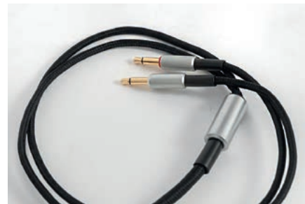
Z drugiej strony, kabel wpina się wtykami 3,5 mm, niezależnie do każdej z muszel. Kable obydwu kanałów „zbiera” elegancka tuleja, a kable na wszystkich odcinkach mają efektowną, plecioną izolację.
