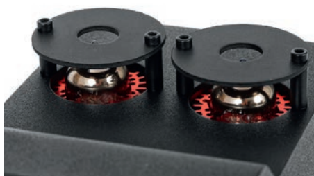
Na górnej ścianie głębokiej obudowy efektownie prezentują się dwie lampy pracujące w stopniu wyjściowym.
