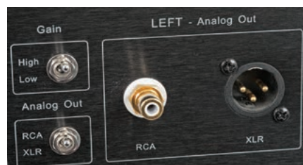
Wyjścia analogowe RCA oraz XLR mają stały lub zmienny poziom napięcia, niezależnie od precyzyjnej regulacji przygotowano także przełącznik zakresów (2V/4V).
