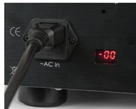
W zagłębieniu okienka umieszczono niewielki wyświetlacz "miękkiego" startu.
