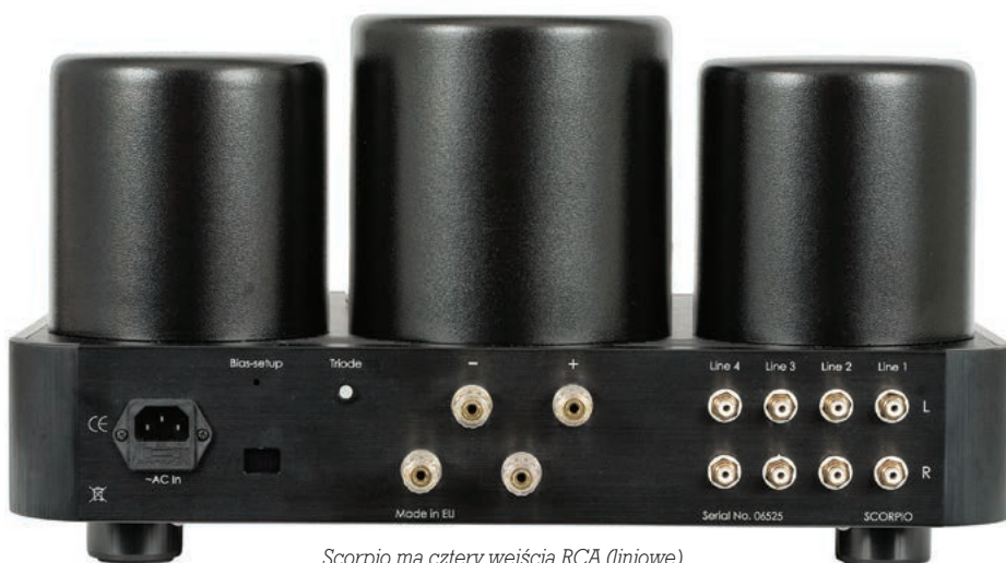
Scorpio ma cztery wejścia RCA (liniowe) i jeden zestaw wyjść głośnikowych.
