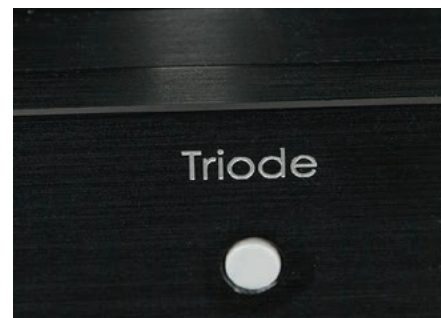
Urządzenie może pracować w dwóch trybach – pentody oraz triody. Ta pierwsza zapewnia wyższą moc wyjściową.
