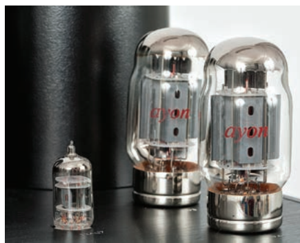
Ayon sygnuje lampy własnym logo, w końcówce mocy każdego kanału pracują dwie KT88.
