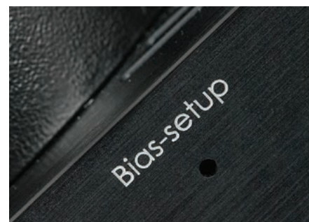
Ciekawym rozwiązaniem jest układ automatycznej kalibracji lamp potrzebny wtedy, gdy przyjdzie czas na ich wymianę.
