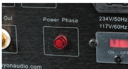
Na tylnej ściance odtwarzacza znajdziemy też wskaźnik poprawności instalacji sieciowej (położenie piny gorącego).
