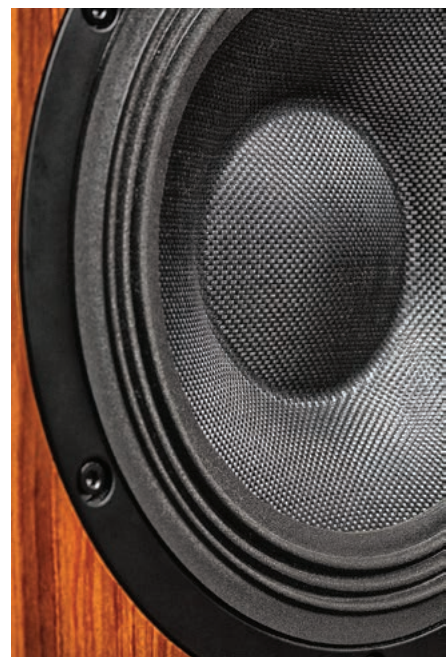
Widoczna z zewnątrz plecionka z włókna aramidowego jest tylko jedną z kilku warstw tworzących bardzo mocną strukturę. Wytrzymałość poprawia też wytłoczenie całej membrany z jednego kawałka – centralna, wypukła część nie jest doklejana. Uwagę zwraca też zawieszenie – złożone z kilku mniejszych fałd, a nie jednej dużej (mimo to pozwala na pracę głośnika z dużymi amplitudami).
