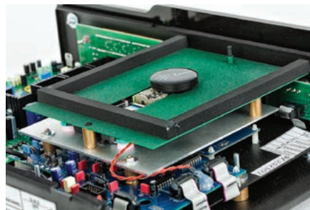
Komplet przetworników zainstalowano na oddzielnej płytce drukowanej – to nieprodukowane już Burr-Brown PCM1704.
