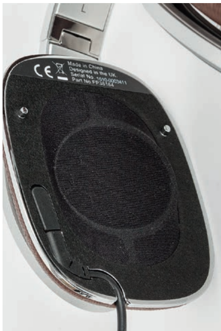
Aby wymienić kabel, należy zdjąć poduszkę i chwilę „podłubać”. W zamian, dzięki takiemu rozwiązaniu, kabel łatwo się wypnie.
