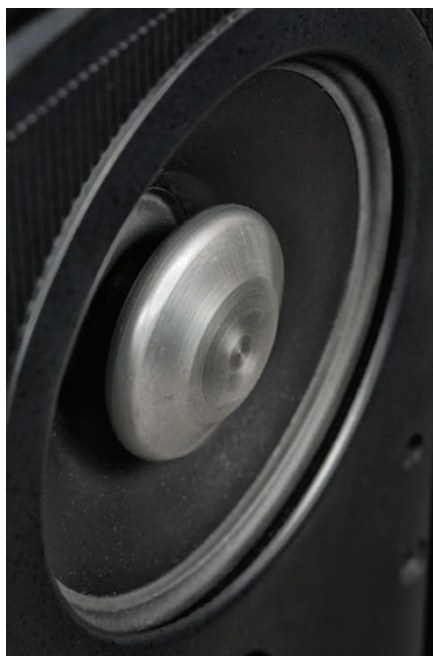
Głośniki nisko-średniotonowe są bardzo wytrzymałe. Nie będąc filtrowane górnoprzepustowo, muszą przyjmować dużą moc. Znajdujący się w centrum membrany (ale sam nieruchomy) „falowód” ma niezwykle kształt służący uzyskaniu najlepszej charakterystyki w zakresie średnich tonów. Wykonany z aluminium, działa też jako radiator.
