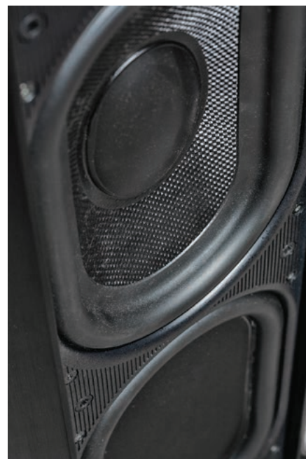
Wśród trzech „stadionów” tylko środkowy jest głośnikiem; zewnętrzna powierzchnia membrany pokazuje plecionkę z włókna szklanego, prawdopodobnie usztywnioną warstwą twardej, polimerowej pianki.
