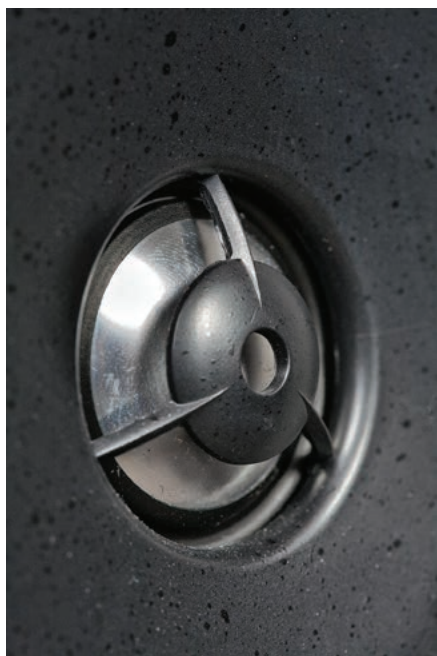
Kopułka aluminiowo-magnezowa jest zabezpieczona dyfuzorem; być może to właśnie on, tworząc przed wierzchołkiem kopułki miniaturowy układ rezonansowy (akustyczny filtr dolnoprzepustowy), wywołuje podcięcie przy 10 kHz i spadek powyżej – czy celowo?
