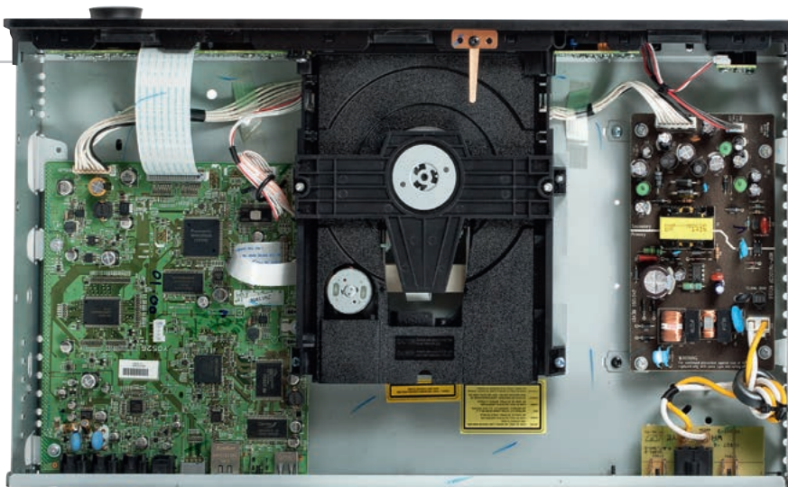
Konstrukcja składa się z czterech głównych sekcji: mechanizmu, logiki sterującej, zasilania oraz płytki audio.
