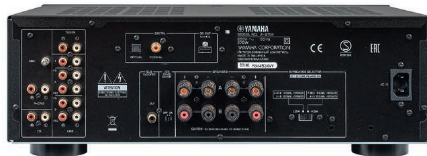
A-S701 wykazał się rekordową liczbą wejść i wyjść, system zbudowany w oparciu o ten wzmacniacz może być bardzo rozległy. Priorytetowe i odsunięte od pozostałych są dwa wejścia - dla odtwarzacza CD i gramofonu.
