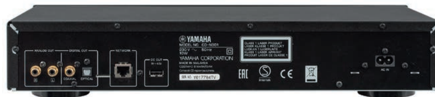
Tylny panel ogranicza się do połączeń przewodowych, nie ma tu systemów Wi-Fi czy Bluetooth.
