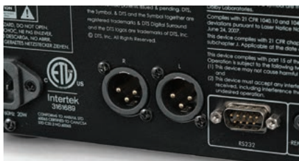
Oprócz standardowego wyjścia na parze RCA, Arcam ma także parę gniazd XLR.
