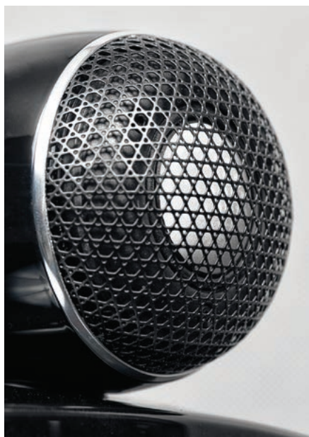
Nowy wzór siateczki osłaniającej diamentową kopułkę, stosowany tylko w serii D3 , zapewnia zarówno pewną ochronę, jak też bardzo dobrą „przejrzystość” akustyczną. Równie ważne dla dobrych charakterystyk jest zaokrąglenie wokół kopułki (wycinek torusa), czyli brak krawędzi odbijających fale.
