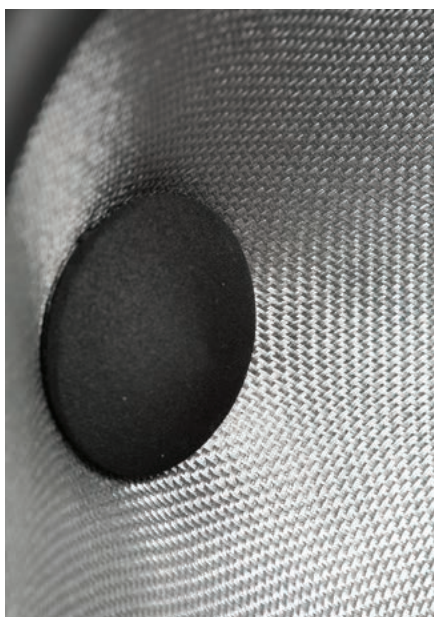
Plecionka Continuum wydaje się mieć drobniejszy spłot niż Kevlar. Podobno jest ona połączeniem dwóch rodzajów włókien, ale jakich dokładnie – firma trzyma w tajemnicy. W centrum membrany nie pojawia się już nieruchomy korektor fazy, ale gąbczasta nakładka (raczej wkładka...) przeciwpływowa.
