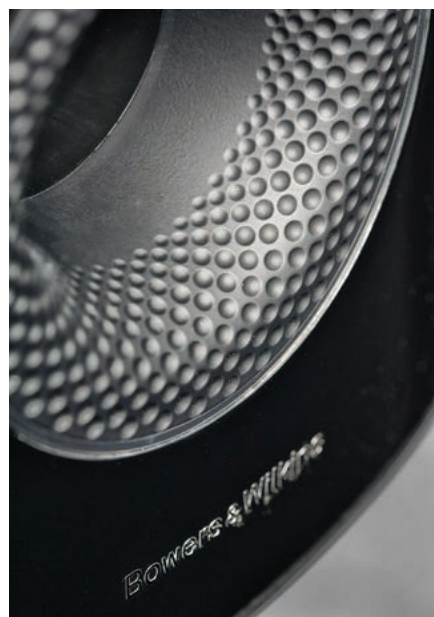
Wprowadzony już wiele lat temu „Flow-port”, czyli wyprofilowanie wylotu wzbogacone o drobne wklęsłości, ułatwia przepływ laminarny przy większych prędkościach ruchu cząsteczek powietrza, zmniejszając kompresję i szumy turbulencyjne. W komplecie jest pierścieni i zatyczka, które pozwalają na przestrojenie układu.
