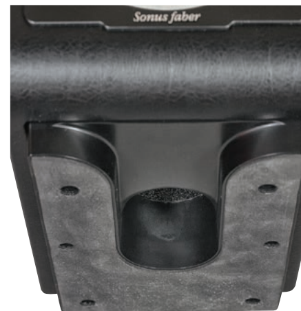
Bas-refleks wyprowadzono niekonwencjonalnie, ale wygodnie. Okrągły tunel ma wylot w dolnej ścianie, ale nie będziemy musieli martwić się ustawianiem monitorów na nóżkach, bowiem integralną częścią Chameleonów B jest cokół, którego wycięcie tworzy dalszą część tunelu, prowadząc ciśnienie do przodu
