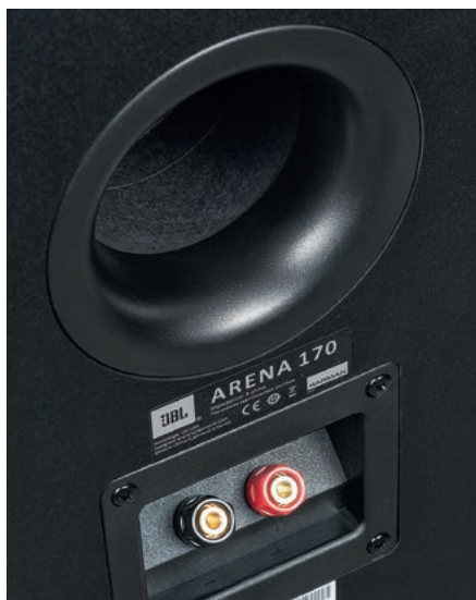
JBL ma w swojej historii konstrukcje z bas-refleksem wyprowadzonym z przodu, firma preferuje jednak „wydmuch” do tyłu. Tunel o średnicy 6,5 cm (i długości 10 cm) pozwala swobodnie przesuwac powietrze pompowane przez jeden 18-cm głośnik nisko-średniotonowy.
