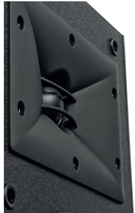
Wysokotonowa tuba Areny jest dodatkiem do konwencjonalnej, 25-mm tekstylnej kopułki, ale poważnie modyfikuje jej charakterystyki; mniejsze znaczenie mają dwie poprzeczki przed samą kopułką, które pełnią już rolę raczej dekoracyjną.
