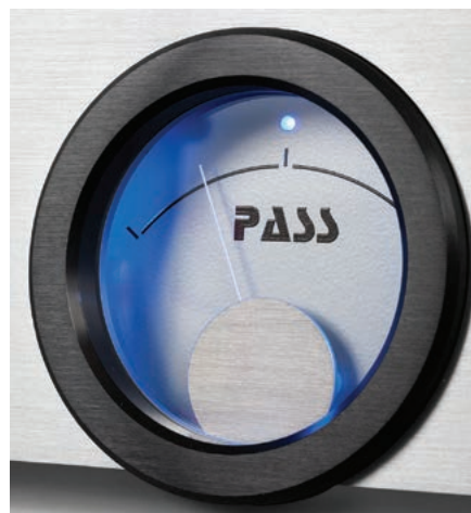
Wskaźnik wychyłowy działa inaczej niż w większości przypadków; nie jest to VU-Metter, ale podgląd prądu pracy tranzystorów wyjściowych.
