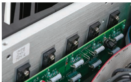
Mosfety to ulubione tranzystory Passa w końcówkach mocy. Nie pożałował – 20 na kanał.
