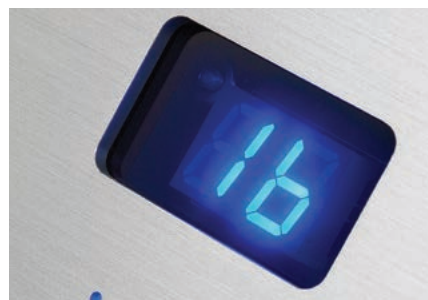
Aktualny poziom wzmocnienia jest prezentowany na niewielkim, dwucyfrowym wyświetlaczu; układ zapewnia 63 poziomy.
