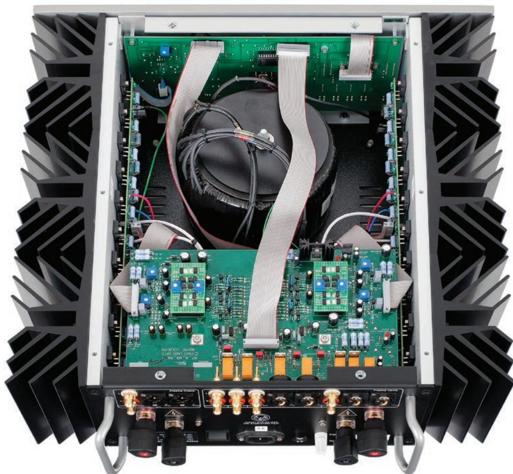
Aranżacja z rozdzieleniem końcówek na dwie strony i ulokowaniem przedwzmacniacza oraz zasilacza w środku jest typowa dla wzmacniaczy tej klasy.
