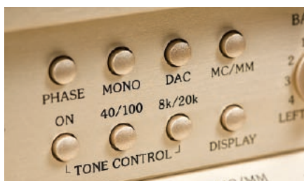
W ramach regulacji barwy dźwięku wybieramy tzw. „turnover frequency”, dla niskich tonów może to być 80 lub 100 Hz, a dla wysokich 8 lub 20 kHz.
