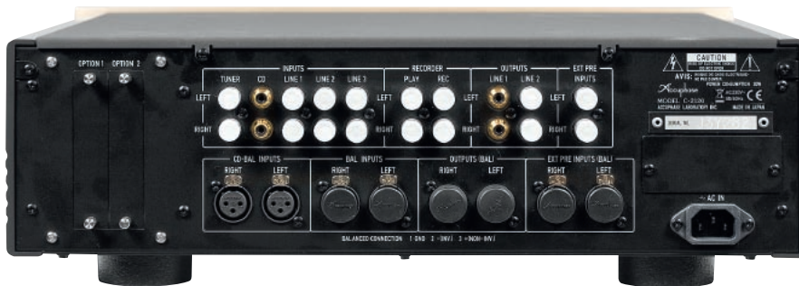
Gniazda wejściowe i wyjściowe w dwóch rzędach – na górze RCA, na dole XLR. Z boku widać dwa sloty (tutaj zamknięte) na opcjonalne płytki – np. przetwornika cyfrowo-analogowego, przedwzmacniacza gramofonowego lub z dodatkowymi wejściami liniowymi.
