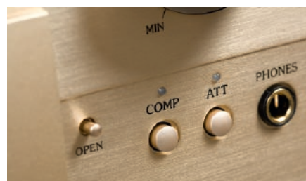
Na zewnątrz pozostawiono kilka najważniejszych manipulatorów – m.in. skokowe zmniejszenie wzmocnienia („att”) o 20 dB oraz loudness („comp”), wzmacniający skraje pasma.
