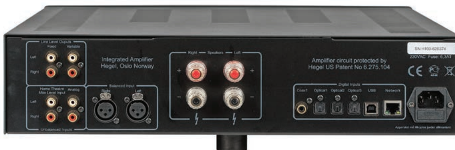
Rozdzielenie wejść analogowych i cyfrowych wiąże się z odseparowaniem układów wewnątrz, ale pomagają też w utrzymaniu porządku połączeń zewnętrznych.
