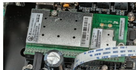
Umieszczony nad główną płytką cyfrową dodatkowy moduł odpowiada za komunikację w sieci LAN.
