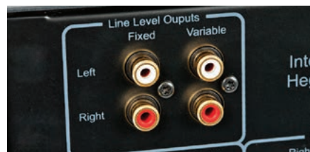
Z sekcji przedwzmacniacza można wydobyć sygnały o stałym i zmiennym poziomie.
