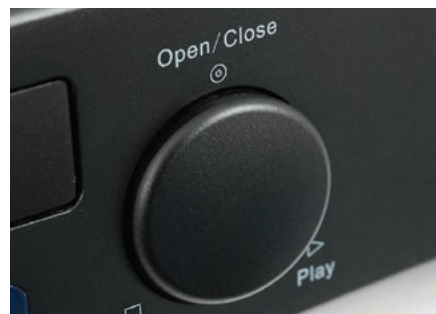
Wyglądają jak pokręta, ale pod okrągłą gałką ukryto trzy przyciski; do obsługi odtwarzacza służą dwa takie manipulatory.
