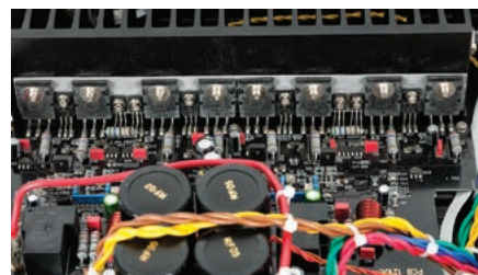
Stopnie wyjściowe tworzy aż osiem (po cztery na kanał) tranzystorów mocy marki Sanken.
