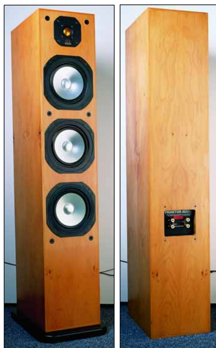
Fot. Mimo dominacji obudów bass-reflex, obudowa zamknięta, przede wszystkim dzięki dobrym właściwościom impulsowym, ma wciąż swoich zwolenników. Na zdjęciu brytyjska kolumna Monitor Audio Studio 50, której wszystkie głośniki pracują w zamkniętych komorach.
