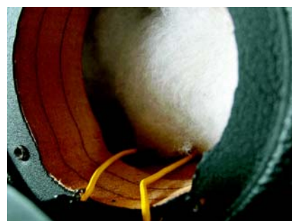
Po wyjęciu głośnika wysokotonowego widać, że ścianka przednia została sklejoną z trzech warstw płyty HDM.
