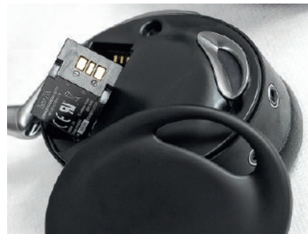
Pod dekletem mocowanym na magnesiki ukryto firmowy akumulator – wymiana beznarzędziowa.
