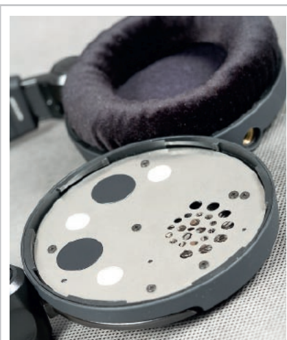
Zestaw różnej wielkości i różnie tłumionych otworków – słuchawki z systemem S-Logic to precyzyjnie dostrójony ustrój akustyczny.
