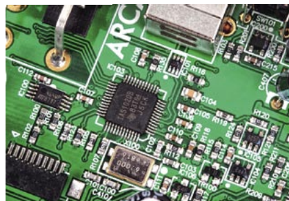
TAS1020B, programowalny odbiornik USB, tutaj z oprogramowaniem przygotowanym przez dCS-a. Bomba!
