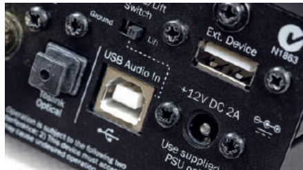
Wejście USB przyjmie teraz (w nowej wersji Dac Magica) sygnał do 24 bitów i 192 kHz.
