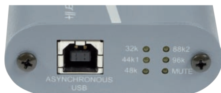
Wejście (jedno jedyne, ale z diodami wskazującymi częstotliwość próbkowania) po jednej stronie...
