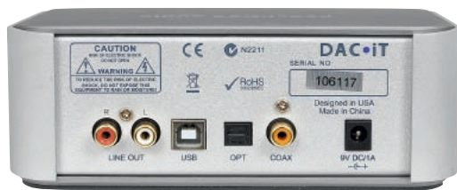
Kompletne wyposażenie w trzy najważniejsze standardy wejść, USB akceptuje sygnały 24/96.
