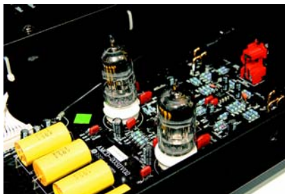
Szczególną cechą odtwarzacza jest lampowy bufor wyjściowy.
