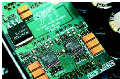
Płytki przetwornika (jeden kanał) - zbudowana przy użyciu elementów SMD.
