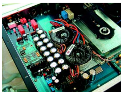
Bank kondensatorów większy niż u wielu wzmacniaczy. Obok dwa transformatory. A to tylko jeden kanał...
