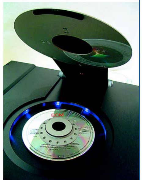
Mikado z podniesioną klapą, z boku krążek dociskowy.
