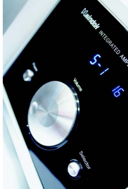
Pokrętko steruje logiką, w tym wskazaniem siły głosu na wyświetlaczu.
