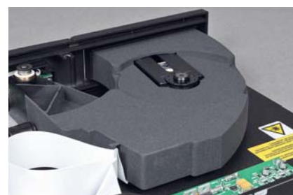
Szufladę wykonano ze specjalnego tworzywa tłumiącego vibracje. Napęd oparto na module Philipsa z serii VAM.
