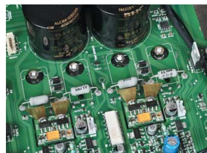
Tranzystory końcowe przykręcono do obudo- wy za pośrednictwem elementów z ceramicz- nych spieków.
