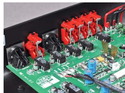
Sekcję tranzystorów sterujących oddzielono od płytki głównej.
