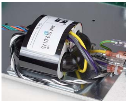
Transformator R-core jest charakterystyczny dla urządzeń japońskich – to kosztowna odmiana toroidu.
