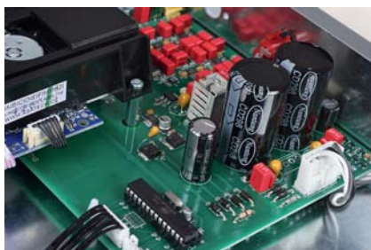
Zasilanie znalazło się tuż przy układach, którym jest dedykowane.
