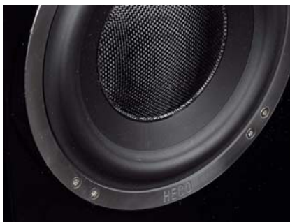
Decyzję o usztywnieniu membrany niskotonowej dużą nakładką ułatwia fakt, że membrana nie musi mieć tutaj jak najniższej masy.
