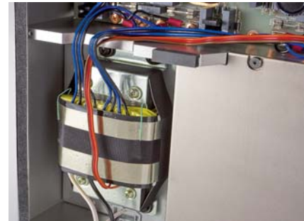
Szczelnie zaekranowany transformator przypomina „podwójne C”.
