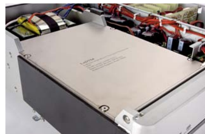
Grube boczne płyty osłony napędu, a do nich przykręcona od góry równie gruba płyta zakrywająca mechanizm.
