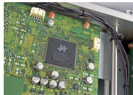
Płytką sterującą napędem, z kością Mediateka, coraz częściej zastępuje wszechobecną niegdyś w odtwarzaczach SACD kość dekodującą Sony.
