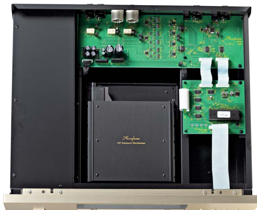
Przetworniki cyfrowo-analogowe - po jednym dwukanałowym układzie na kanał w firmowej aranżacji MDS++.
