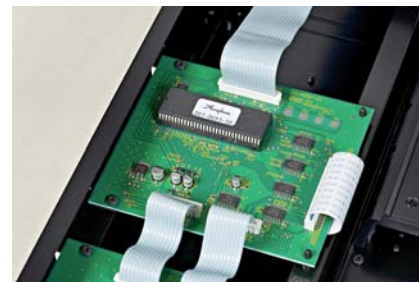
Accuphase do własnego napędu opracował też płytkę ze sterowaniem.
