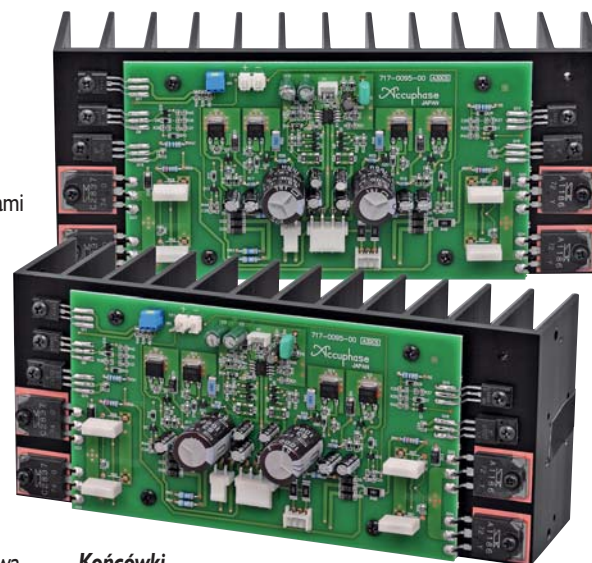
Końcówki mocy to dla każdego kanału oddzielny moduł z własnym radiatorem.
