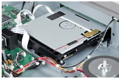
Napęd w Rotelu to jednostka DVD sterowana kością Mediateka.
