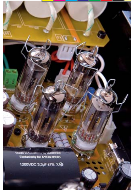
Lampowy mostek prostowniczy złożony z czterech diod.
