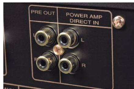
Wyjście z przedwzmacniacza i wejście na końcówkę mocy to dopełnienie bogatego wyposażenia.
