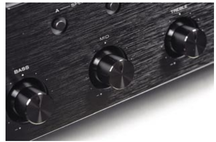
Regulatory barwy z trzema pokrętkami - dla tonów niskich, wysokich a także średnich.
