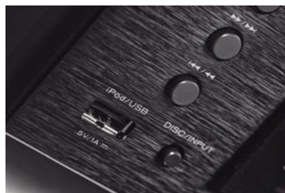
Port USB z przodu to nie tylko okno na pliki MP3 z pamięci flash, ale także możliwość podłączenia iPoda.
