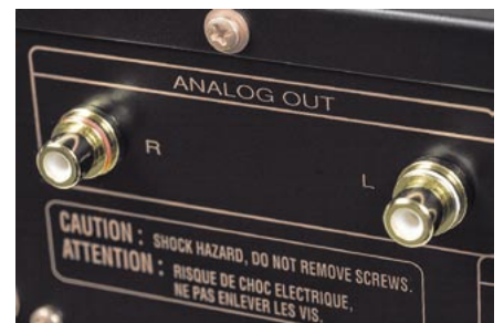
Wszystkie gniazda RCA są złożone, ale specjalnej jakości konektorami uhonorowano wyjście analogowe.
