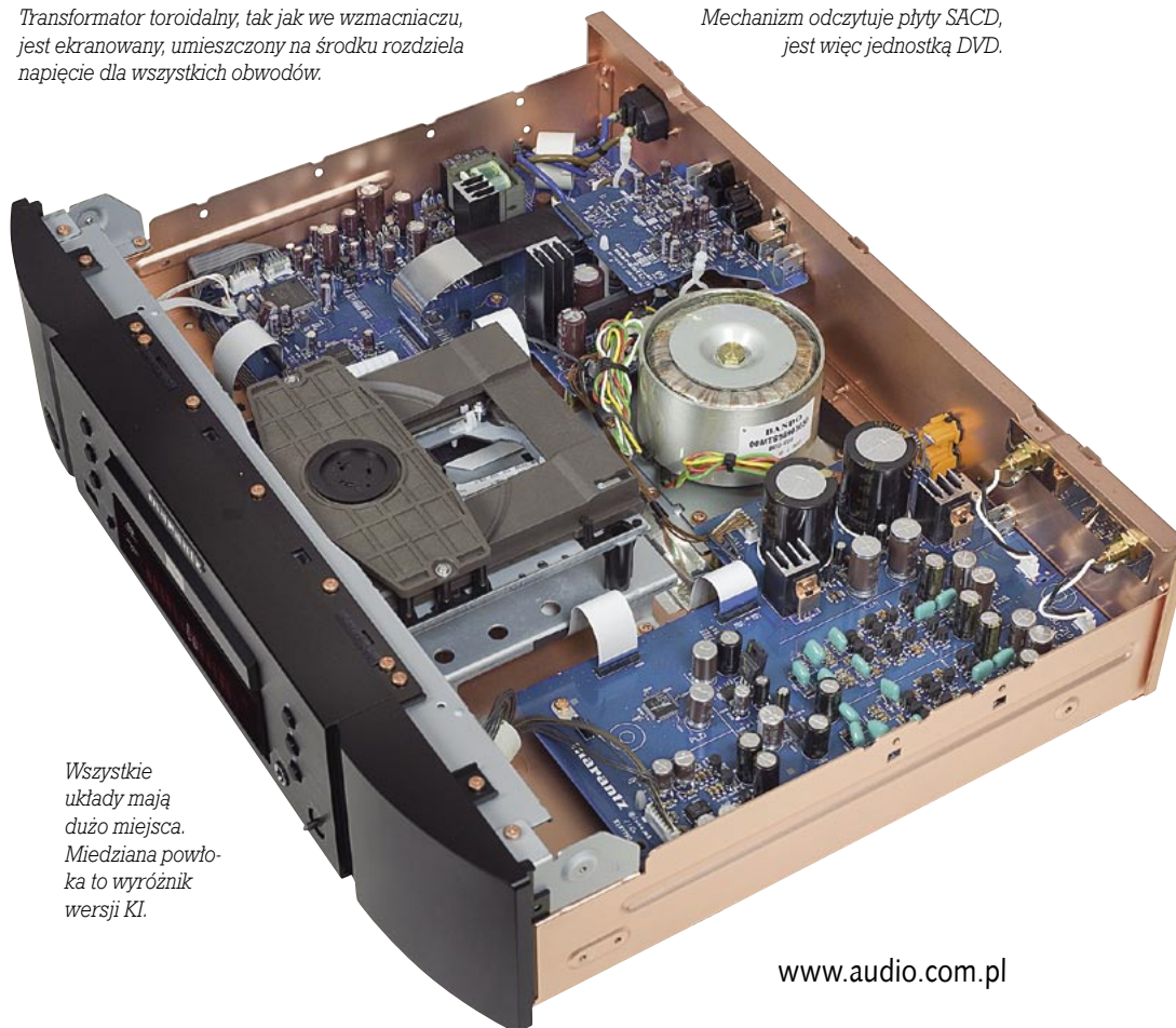
Serce sekcji cyfrowej - konwerter C/A Cirrus Logic.
