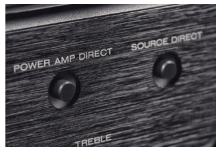
Układy Direct – albo tylko odłączają regulację barwy, albo prowadzą prosto do końcówki mocy.
