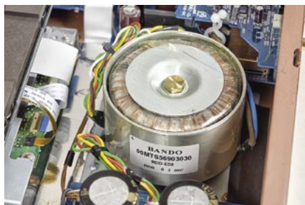
Transformator toroidalny, tak jak we wzmacniaczu, jest ekranowany, umieszczony na środku rozdziela napięcia dla wszystkich obwodów.
