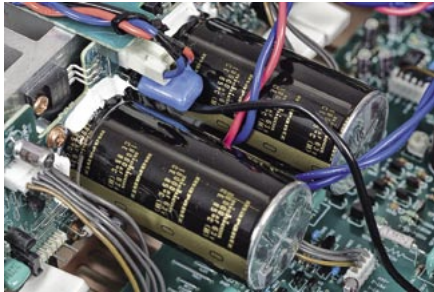
Kondensatory w sekcji zasilania umieszczono tuż przy końcówkach mocy.
