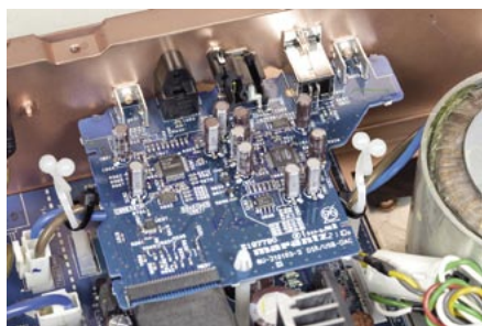
Moduł wejść cyfrowych obsługuje także dane z portu USB.
