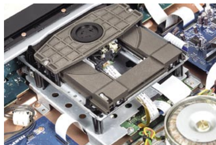
Mechanizm odczytuje płyty SACD, jest więc jednostką DVD.
