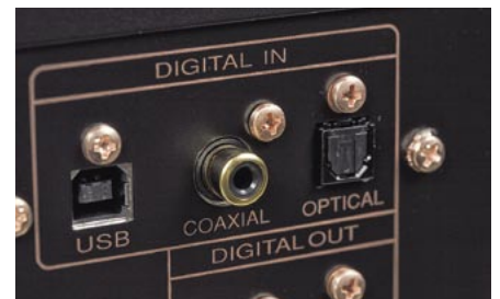
W panelu wejść cyfrowych z tyłu znalazło się drugie złącze USB – dedykowane przede wszystkim sygnałom z komputera.
