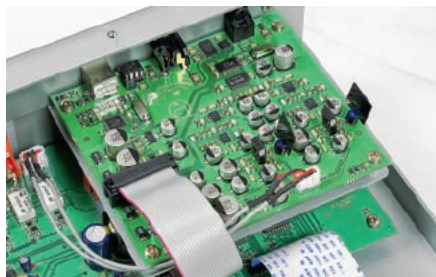
Kompletny DAC wzmacniacza z wejściami USB i S/PDIF przykręcono do grubej płytki ekranującej przedwzmacniacz.
