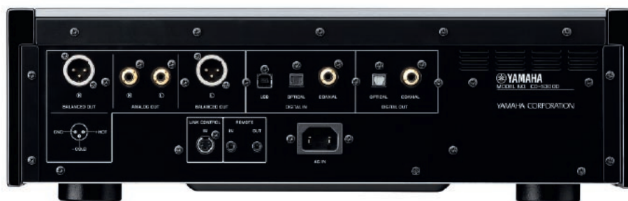
Oprócz typowych dla odtwarzacza CD wyjść analogowych i cyfrowych (te pierwsze również w wersji XLR, w zasadzie podstawowej dla CD-S3000, ze względu na jego zbalansowany tor sygnału), są też trzy wejścia cyfrowe, w tym USB. Urządzenie jest więc też USB-DAK-iem, otwartym na różne zewnętrzne źródła cyfrowe i komputer, chociaż nie jest „pełnym” odtwarzaczem strumieniowym.
