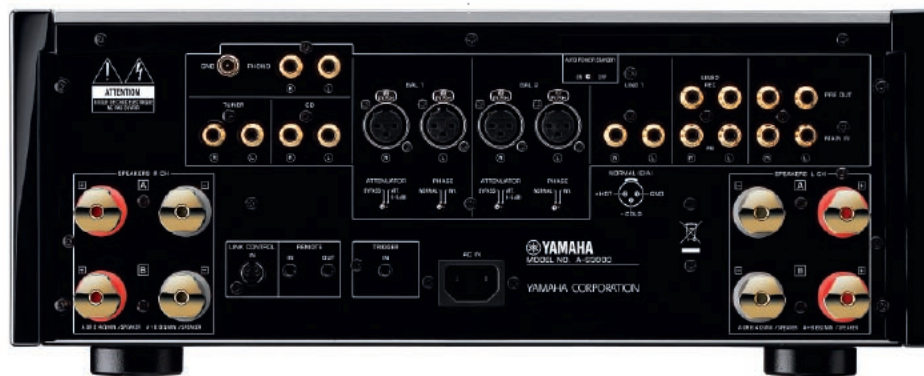
Absolutny wzorzec – to zdjęcie nadaje się do encyklopedii. Na skrajach podwójne pary zacisków głośnikowych, na środku dwie pary wejść XLR, z lewej – część wejść RCA, w tym wejście z korekcją MM/MC, z prawej – pozostałe wyjścia i wyjścia liniowe, na dole gniazda sterowania i sieciowe – dokładnie pośrodku, na wprost transformatora.
