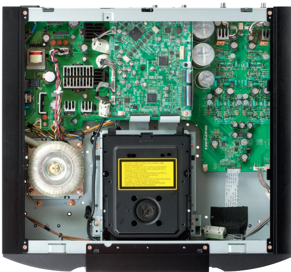
Cały układ cyfrowo-analogowy mieści się na dolnej, dużej płytce. Kontrolę nad odczytem danych z mechanizmu, przepływem informacji z wejść cyfrowych oraz obsługą cyfrowych wyjść prowadzi dodatkowa, umieszczona na górze płytka. Jest ona również odpowiedzialna za wejście USB z przodu, obsługę sprzętu Apple oraz dekodowanie plików audio.
