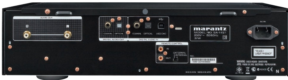
Tylna ścianka to przede wszystkim rozbudowany panel cyfrowy z asynchronicznym portem USB do podłączenia komputera.
