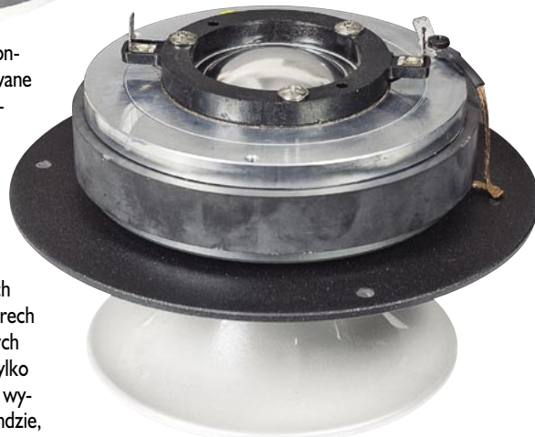
Wysokotonowy od tyłu – mała kopułka tworzy komorę wytlumiającą. Z prawej strony widać przewód uziemienia.
