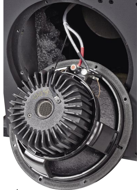
Ich nowa wersja stosowana w G2 wyróżnia się neodymowym układem magnetycznym, osłoniętym dużym radiatorem.
