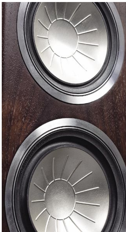
Głośniki niskotonowe i średnionowy różnią się wielkością, ale nie typem membran ani zawieszek; dopasowanie do pełnionej roli może też ukrywać się w układzie napędowym (krótsza cewka przetwornika średnionowego).
